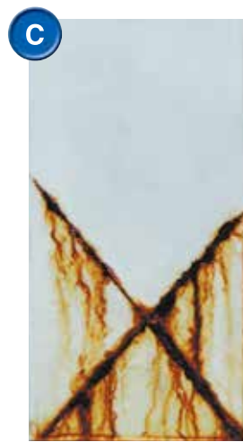
塩化ゴムシステム (5回塗り)
