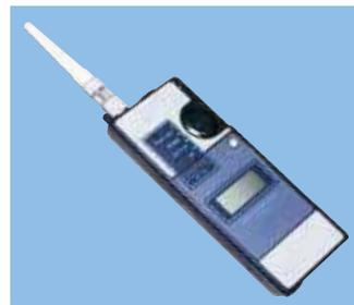
金属酸化物半導体表面でのガス吸着による熱伝導度変化および電気伝導度変化を白金線コイルの両端よりみた抵抗値変化として測定するガスセンサー
