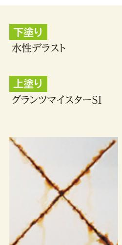
塗装仕様：スレート板面に下塗(1回)+上塗(艶有白・2回)の塗装を行い、JIS K 5600 7-7 促進耐候性及び促進耐光性(キセノンランプ法)を実施
