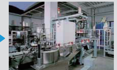
できあがった塗料をろ過して容器に詰めます。
