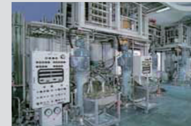
樹脂や顔料、溶剤を混ぜて均一なミルベースをつくります。
