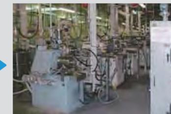
前練のミルベースを分散機に送り、顔料の粒子を細かく分散します。
