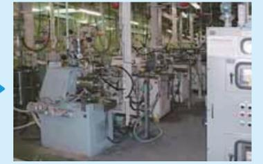
前練のミルベースを分散機に送り、顔料の粒子を細かく分散します。
