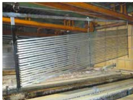
▲アルミサッシ電着塗装(横吊り)
