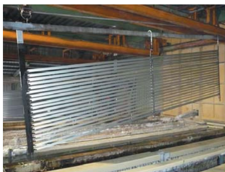
▲アルミサッシ電着塗装（横吊り）
