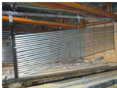
▲アルミサッシ電着塗装（横吊り）
