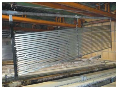
▲アルミサッシ電着塗装（横吊り）
