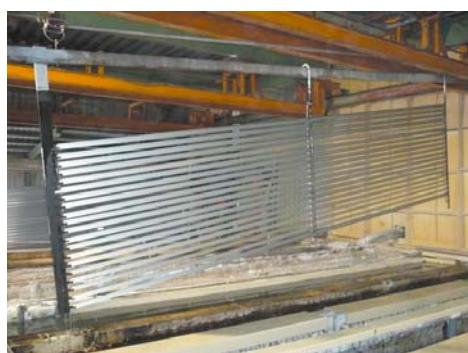
▲アルミサッシ電着塗装（横吊り）
