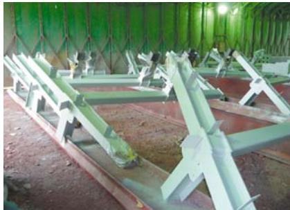
「超速乾リンサンデラストHB」は、速乾・厚膜・省工程を可能にした鉛・クロムフリーさび止めペイントで、一般建築物、鉄鋼構造物、橋梁、プラント等の鉄部用に適しています。
